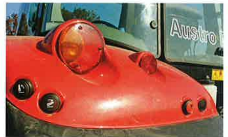
Heckkraftheber über Druckknöpfe bedienbar.
