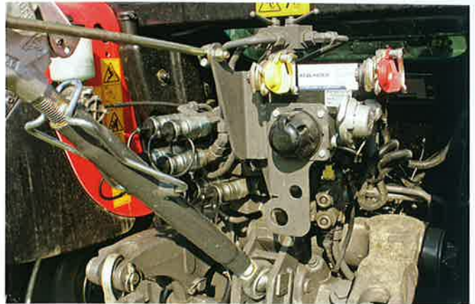
Übersichtliche Anschlüsse für Hydraulik, Licht und Druckluft.
