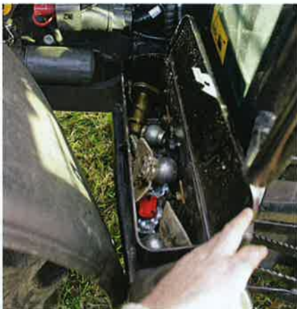
Werkzeugbox: Fasst locker Schraubenschlüssel und Ersatzkugeln für die Fanghaken.
