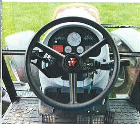
Aufgeräumtes Cockpit mit dem ITCS-Monitor links über dem Power-Control-Hebel.
