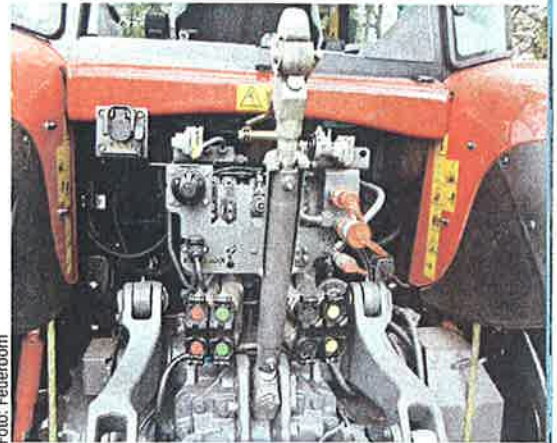
Aufgeräumtes Heck mit 7,1 t Hubkraft, vier Hydraulikanschlüsse und Loadsensing.
